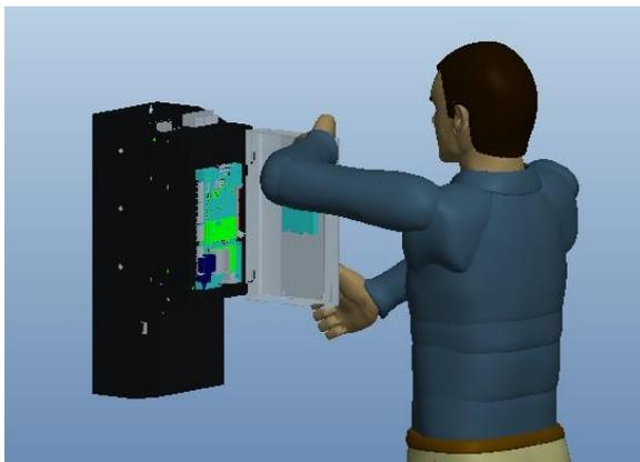
4)：待连接完控制线束和一些插卡的线束后，按相反的顺序将上盖归位。
