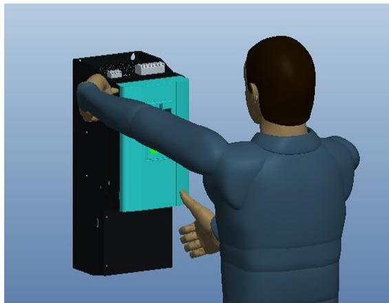
2)：用右手托住上盖底部，用力向上托起，到位后，双手可以将上盖取下
