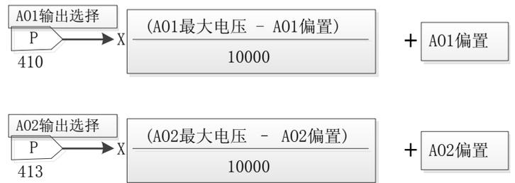
图5-8 模拟量输出内部组态连接图
